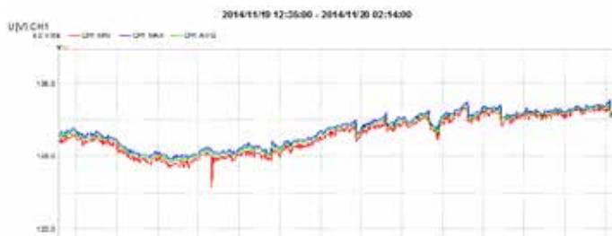
134,6 V con un voltaje de referencia de 120 V. tal como se aprecia en la figura 8.
