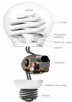
Figura 4. Estructura de una lámpara de Mercurio
