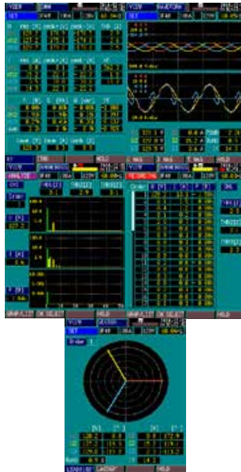
Figura 7. Parámetros que se miden con el analizador HIOKI 3197.
